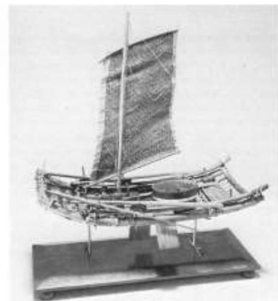
図10：台湾・アミの人びとが外洋で使う帆走竹筏の模型
